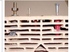
Tipp Bei gebrochenen Innenstegen durch falsches Bohren (z. B. Schlagbohren) sollten Injektionsdübel verwendet werden.
